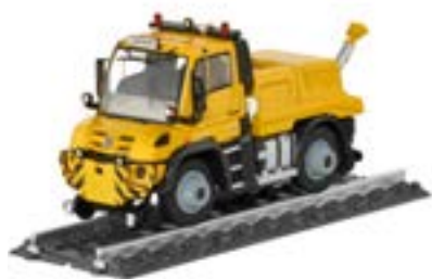
UNIMOG U430 VEHÍCULO BIVIAL CON ESTRUCTURA DE MANIOBRA
